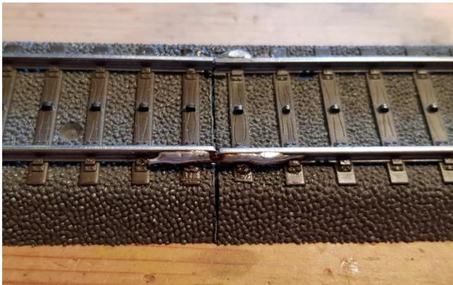
Man tupft mit einem Wattestäbchen ganz wenig Lötöl auf die **Außenseite** der beiden Außenschienen, verzinnt sie und legt ein kurzes – 15mm langes – Stückchen Kupferdraht darauf, dass mit eingelötet wird und die Außenschienen fest miteinander verbindet.
